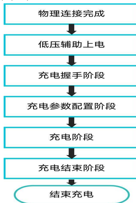
直流充电桩充电工艺流程图
