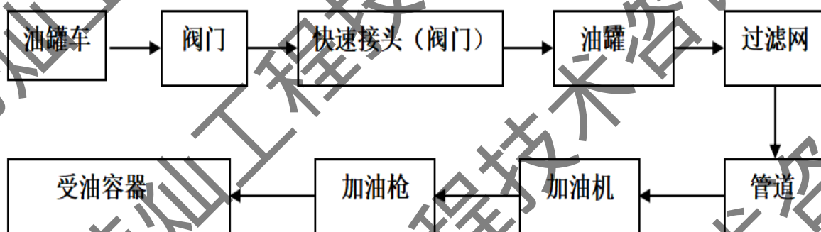
图 2.2.8-3 柴油卸油、加油工艺流程图
