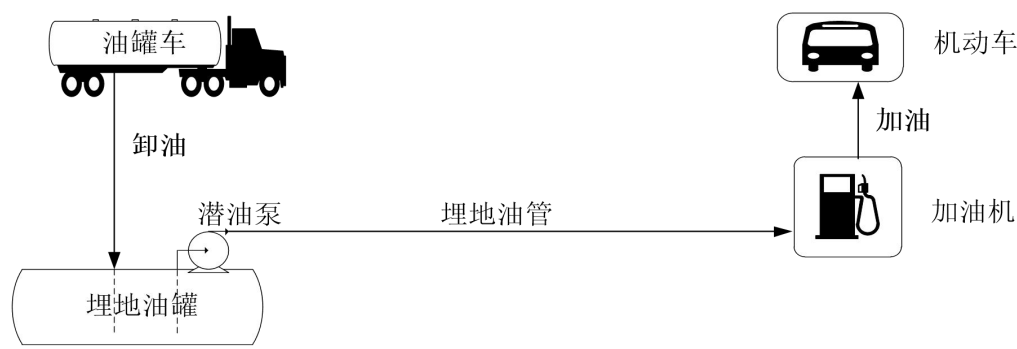
附图 1.2-2 柴油卸油、加油工艺流程图
