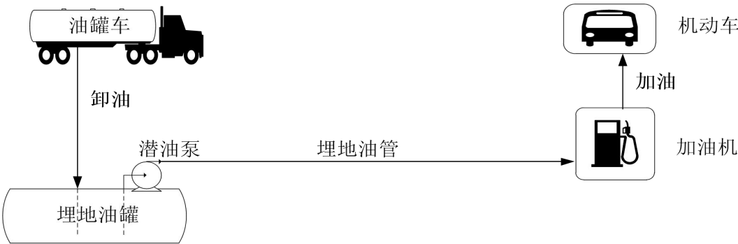
图 2.6-2 柴油工艺流程框图
