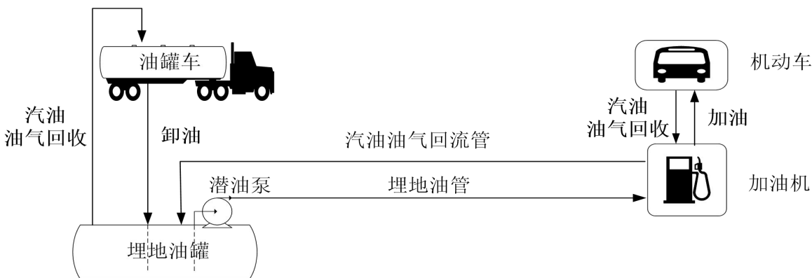
图 2.6-1 汽油工艺流程框图
