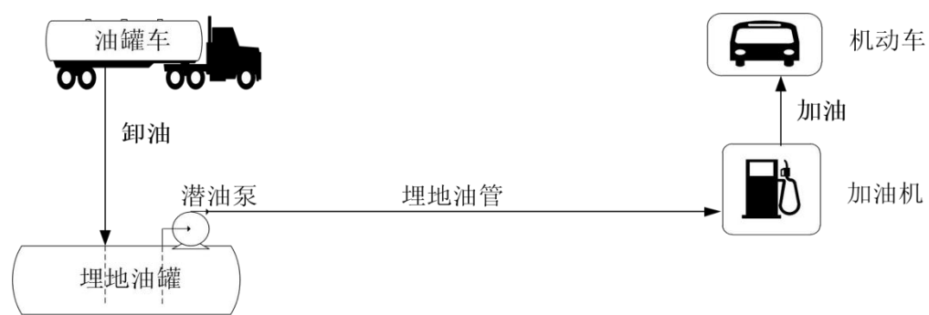
附图1.2-2 柴油卸油、加油工艺流程图
