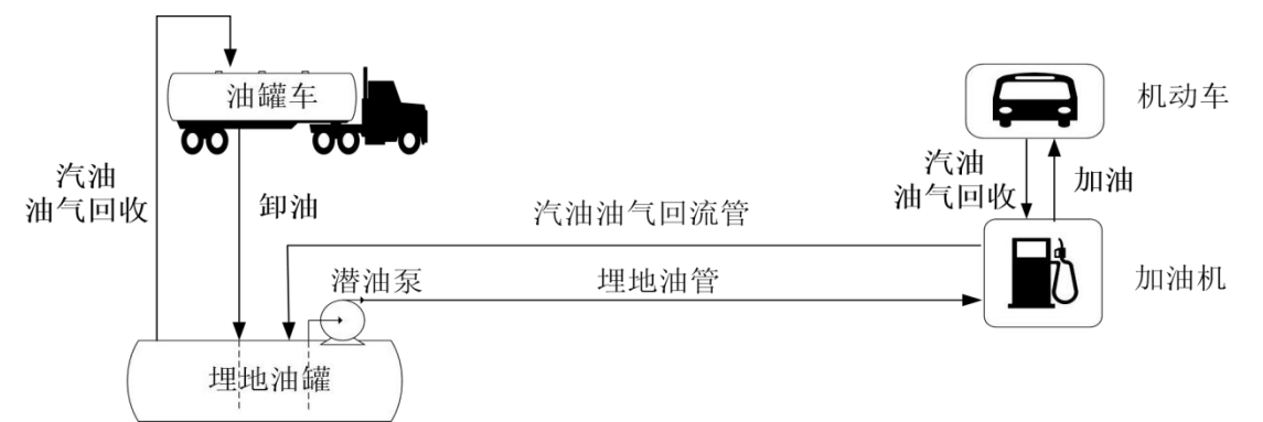
附图1.2-1 汽油卸油、加油及油气回收工艺流程图
