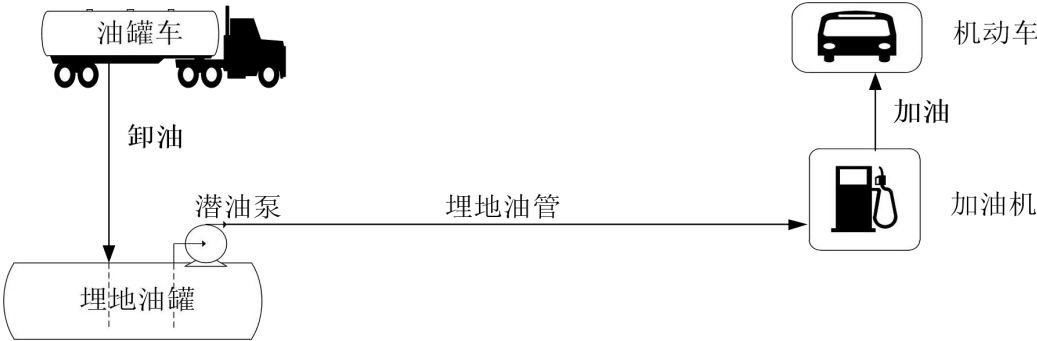
图 2.6-2 柴油工艺流程框图
