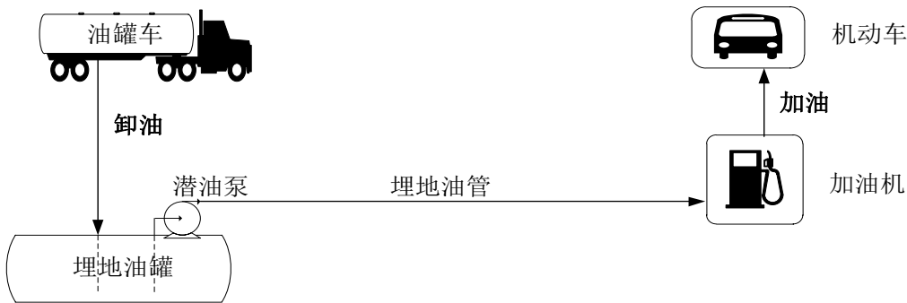
附图 1.2-2 柴油卸油、加油工艺流程图
