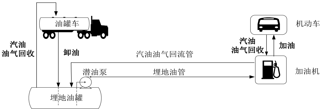
附图 1.2-1 汽油卸油、加油及油气回收工艺流程图
